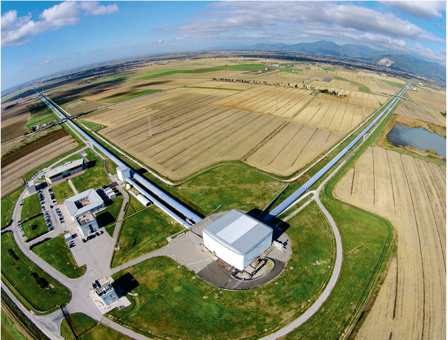
FIGUR 6. Billede af Virgo-detektoren. Der sendes laserlys ud i de to 'arme'. Hvis der passerer en tyngdebølge, bliver længden af armene henholdsvis forkortet og forlænget en lille bitte smule, og det kan måles ved hjælp af laserlyset.
